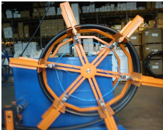
Figura 4- Tubo de PEAD.
