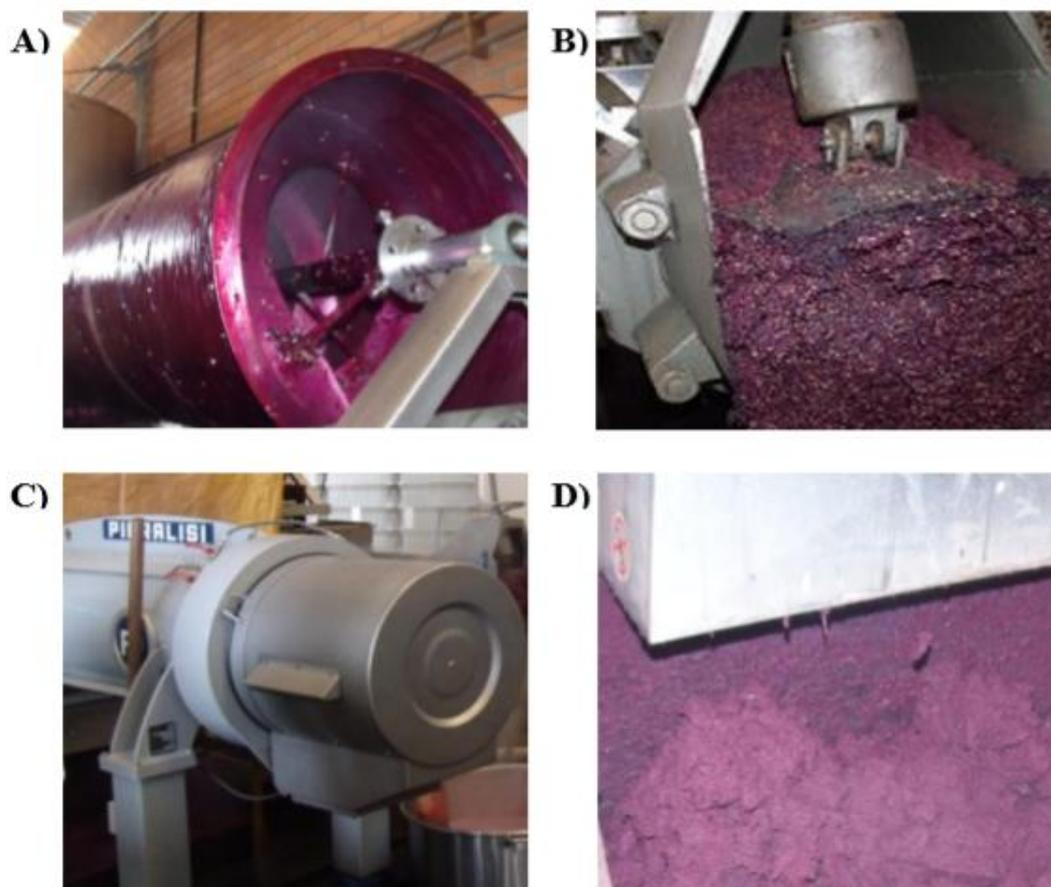
Figura 2 - Etapas do esgotamento e prensagem na produção do suco de uva. A) separação dos sólidos do suco em esgotador; B) prensagem e remoção do bagaço (casca e sementes) e etapa de centrifugação do suco de uva. C) centrífuga decanter; D) resíduo obtido da centrifugação do suco (sólidos suspensos).
