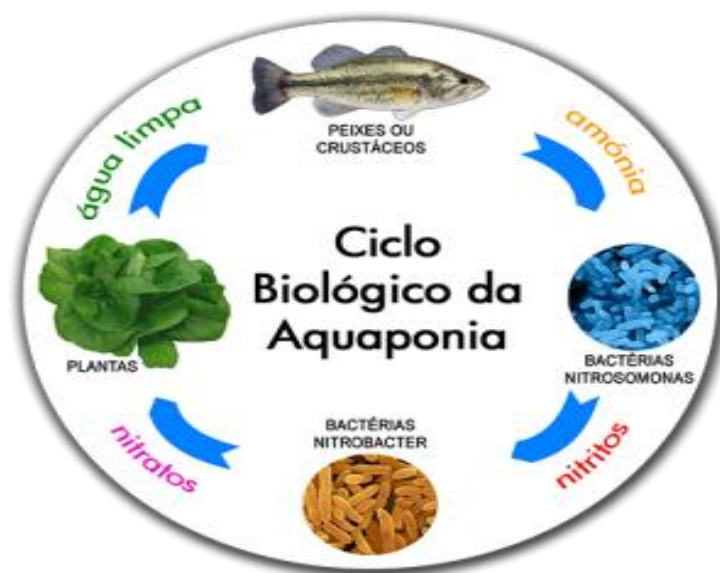
Figura – 2.2 – Processo de transformação: Amônia → Nitrito → Nitrato
