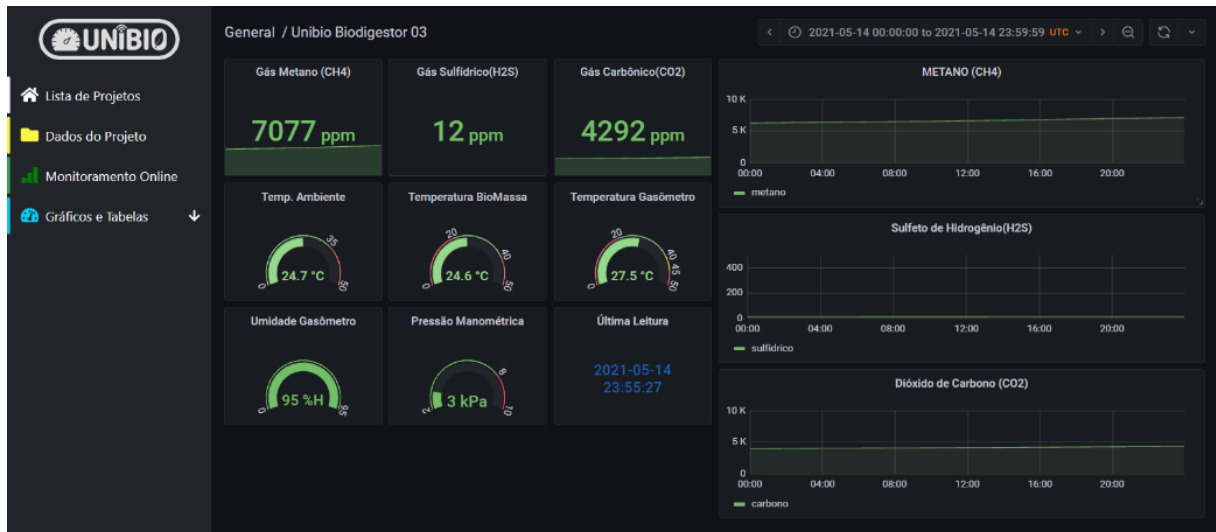
Figura 107 – Tela de monitoramento do Biodigestor
