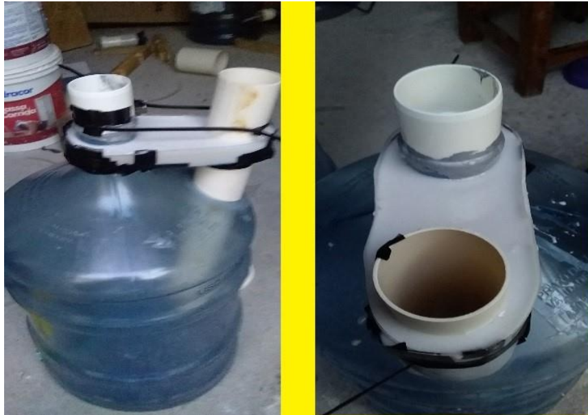
Figura 24 – Processo de Construção do Suporte do Gasômetro
