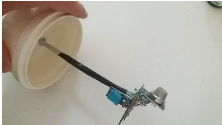
Figura 34 – Montagem do Módulo Sensor
