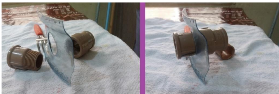
Figura 21 – Exemplo da Sustentação da Válvula de Saída do Biofertilizante
