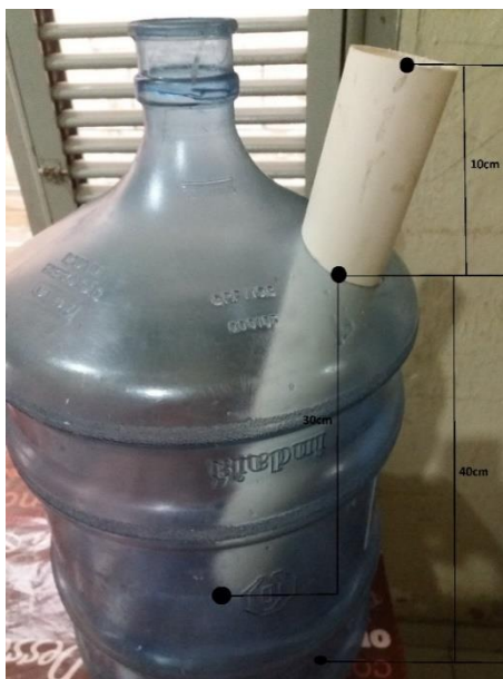
Figura 18 – Tubo encaixado no garrafão.
