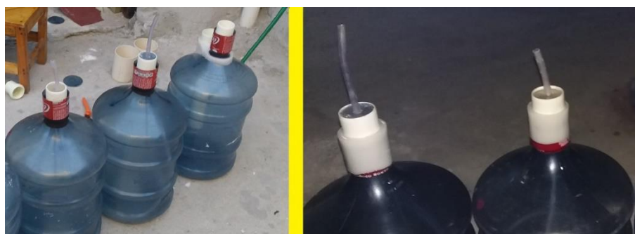
Figura 30 – Vedação dos Gasômetros
