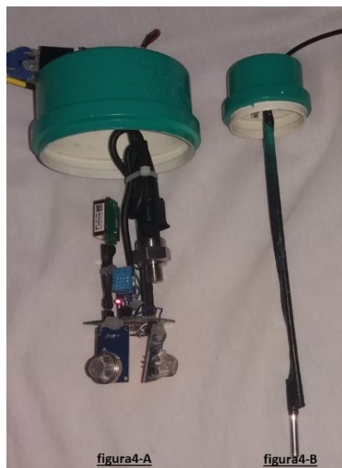
Figura 33 – Fotografia da construção do módulo de sensoriamento
