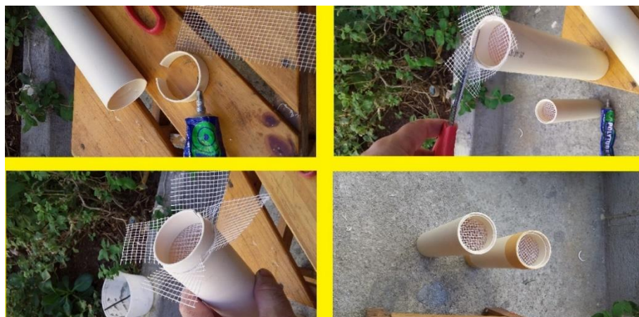
Figura 27 – Compartimentos de Filtros Sólidos Prontos
