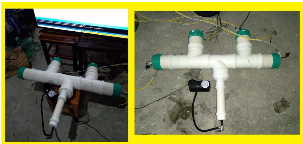
Figura 90 – Equipamento adaptado para a calibração dos sensores de pressão
