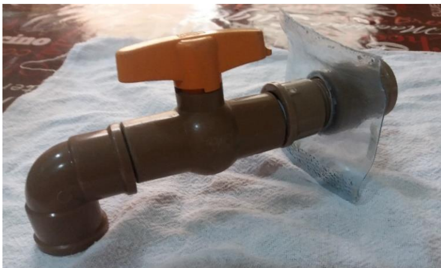
Figura 20 – Válvula da saída de biomassa, recorte lateral
