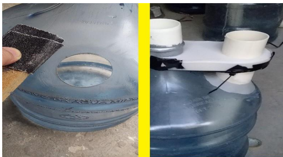
Figura 25 – Vedação da Junção do Tubo Alimentador
