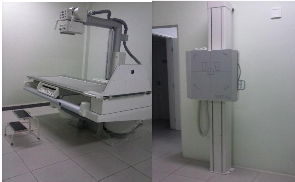
Figura 7: Representação de um equipamento de raios X convencional (a) tubo de raios X e mesa exame; (b) bucky vertical
