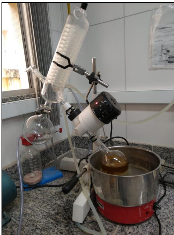
Figura 4.7 - Sistema de evaporação rotativa.
