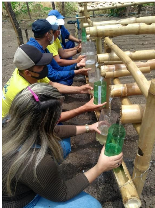
Figura 3 - Teste de vazão do sistema hidropônico
