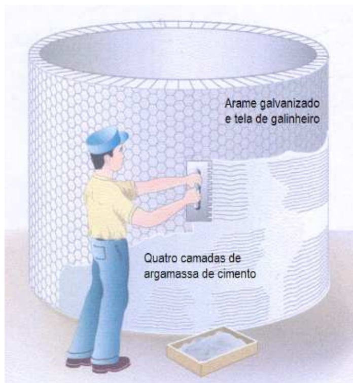
Figura 01: Cisterna de concreto com tela.
