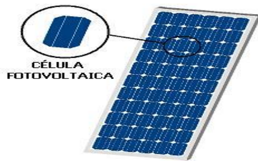
Figura 4. Célula fotovoltaica e módulo fotovoltaico.
