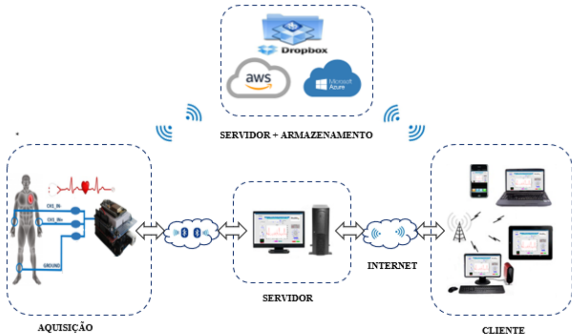
Figura 10 – Arquitetura do sistema proposto.
