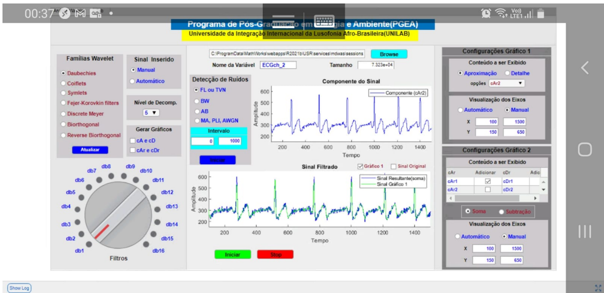
Figura 40 – Interface da aplicação WEB sendo acessada a partir de um smartphone após a aplicação de uma decomposição wavelet de cinco níveis em um sinal de ECG.
