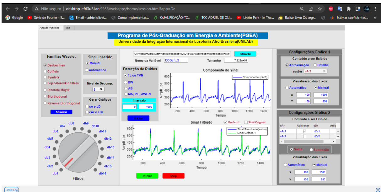
Figura 37 – Interface da aplicação WEB após a aplicação de uma decomposição wavelet de cinco níveis em um sinal de ECG.
