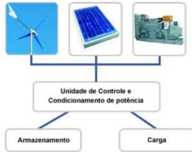
Figura 5: Configuração do sistema eólico híbrido solar-eólico-diesel
