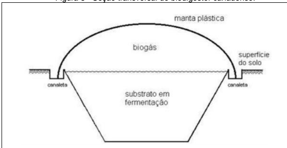
Figura 8 - Seção transversal do biodigestor canadense.
