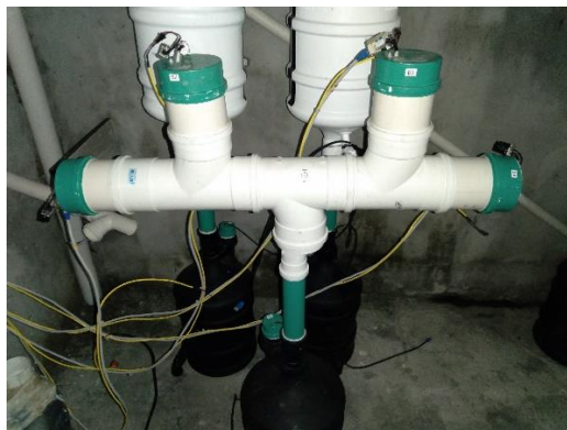
Figura 7. Sistema de calibração utilizado com os sensores empregados nos biodigestores. Fonte: Andrade 2021
