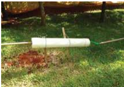
Figura 4. Filtragem do biogás. (Barrichello 2015)
