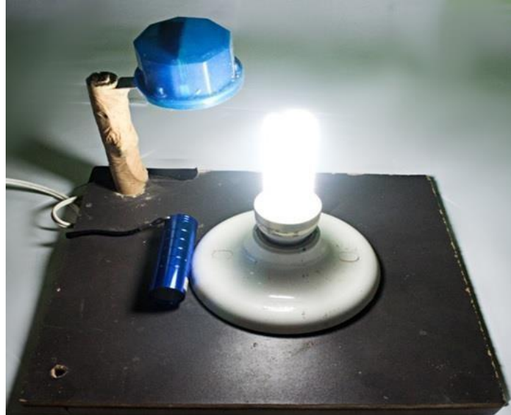
Figura 8: Poste de iluminação pública (conectado e sem incidência de luz)
