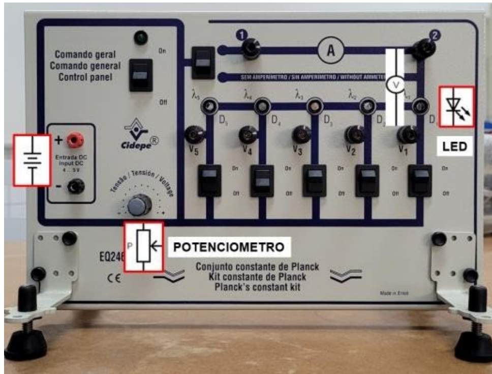
Figura 5 – Painel para conjunto de Constante de Planck por luminescência- EQ246A, Laboratório de Ótica e Física Moderna - UNILAB.
