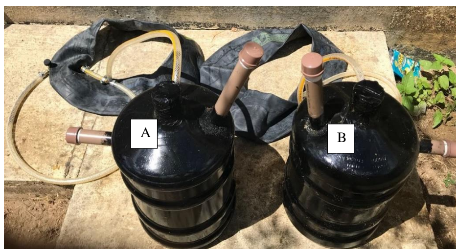
Figura 18. Biodigestores alimentados, A biodigestor com filtro e B biodigestor sem filtro. Fonte: Autor (2018)
