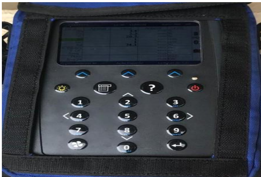
Figura 21. Medidor portátil digital (Landtec GEM™ 5000 Portable Gas Analyzer) Fonte: Autor (2018).
