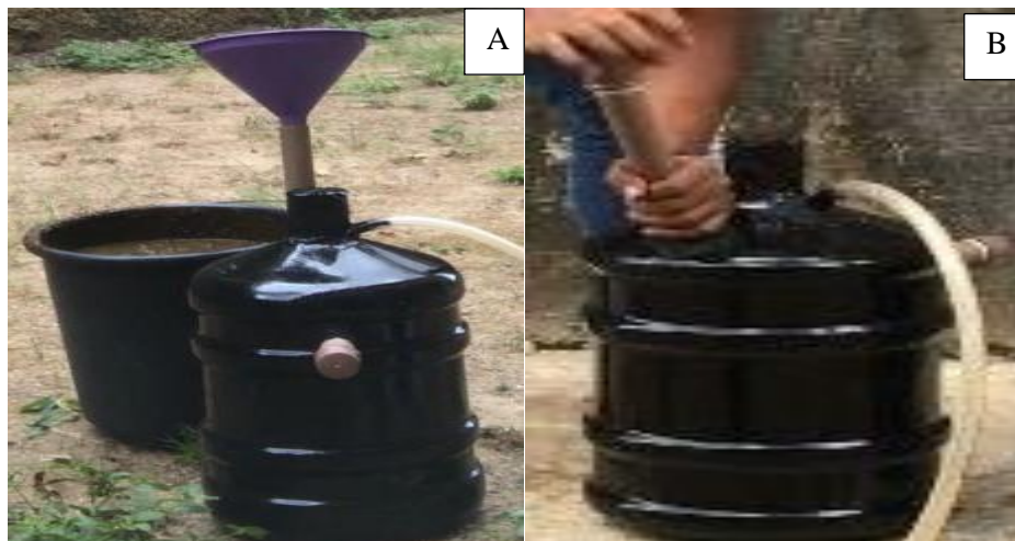
Figura 17. Alimentar biodigestor (A) e fechar tubulação com cap (B). Fonte: Autor (2018)
