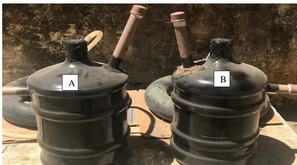
Figura 22. A produção de biogás, quando a câmaras de ar ficaram cheias. A) biodigestor com filtro e B) biodigestor sem filtro. Fonte: Autor (2018).
