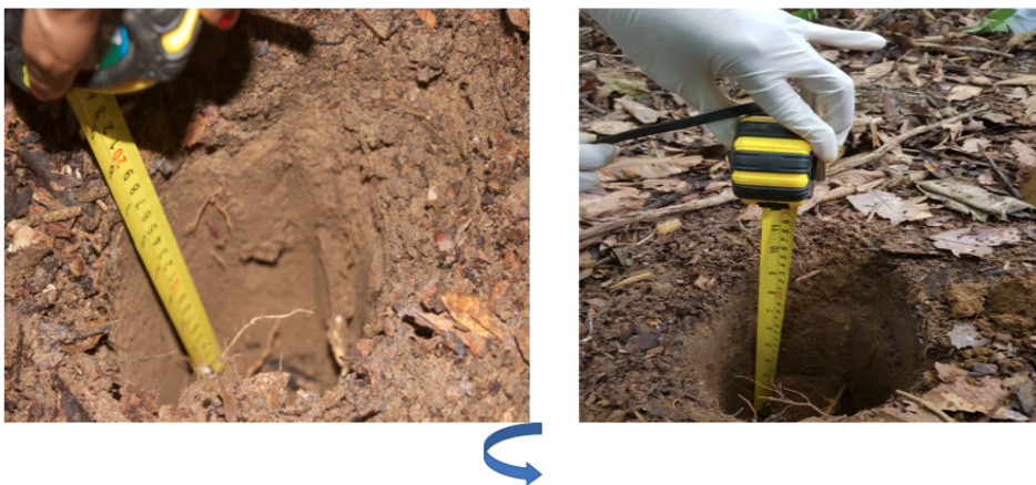
Figura 7. Medição da profundidade do solo. Fonte: Autora, 2018
