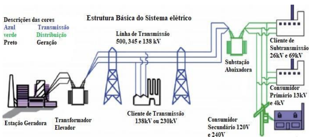
Figura 2– Estrutura do sistema de energia elétrica.
