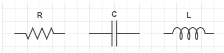
Figura 01 – Elementos passivos de circuitos elétricos: resistor, capacitor e indutor.
