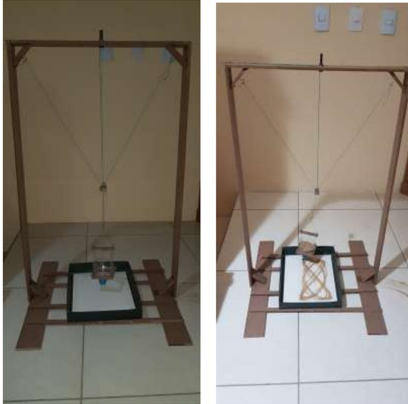
Figure 4.2: Curvas de Lissajous: Demonstração experimental.
