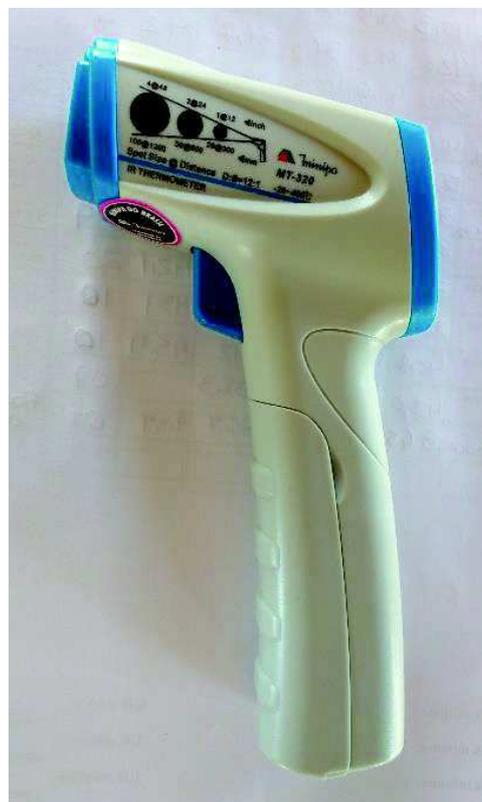
Figura 3. Termômetro digital infravermelho.
