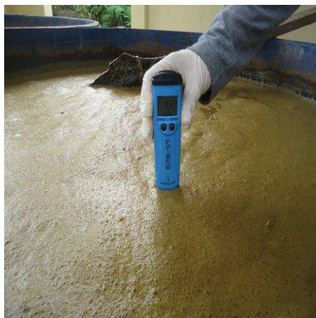
Figura 8 - Monitoramento da condutividade elétrica e temperatura do biofertilizante líquido misto, Redenção, Ceará, 2016.
