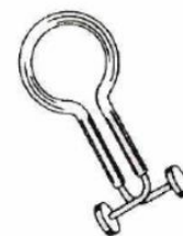
Pinça de Mohr: Usada para impedir ou diminuir fluxos gasosos.
