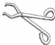
Pinça metálica Castelay: Usada para transporte de cadinhos e outros fins.
