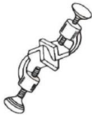
Mufa: Suporte para a garra de condensador.
