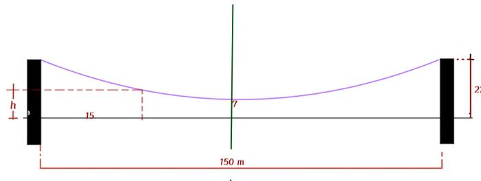
**Solução:** Observe que cada coluna está a  $75m$  do eixo  $OY$  e os pontos de sustentação a  $22m$  do eixo  $OX$ . Neste caso o vértice será  $V = (0, 7)$ .
