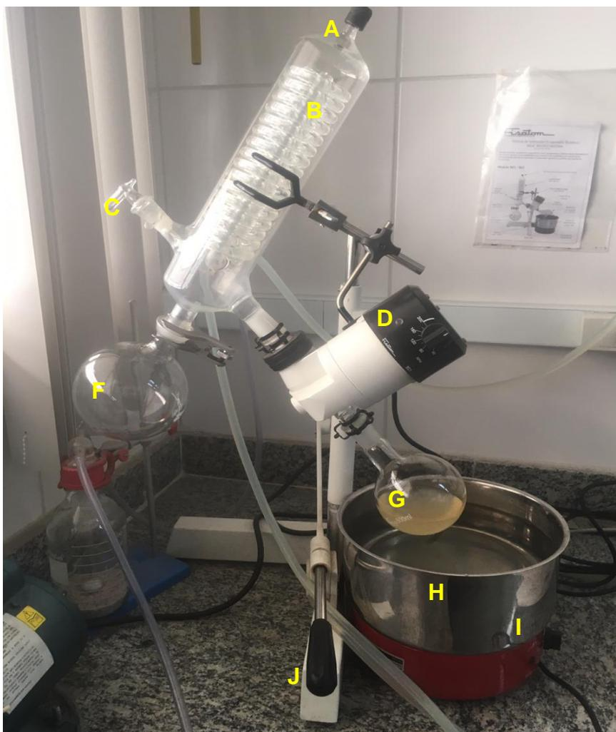
Evaporador Rotativo. Modelo 801/802: (A) Entrada para sonda de temperatura, (B) Condensador, (C) Vidro de válvula, (D) Controle de rotação, (E) Motor, (F) Balão de condensação, (G) Balão de evaporação, (H) Banho de aquecimento, (I) Controle de temperatura.
