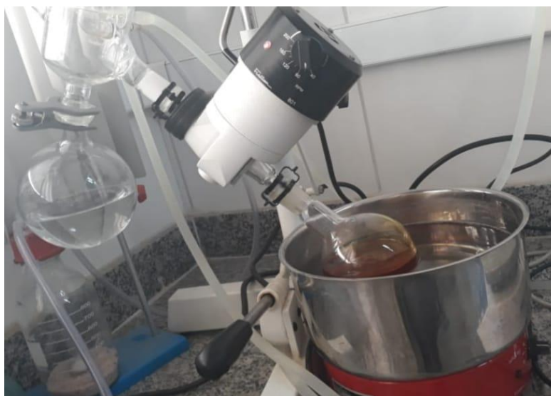
Figura 12 - Processo de retirada do solvente por rotaevaporador.
