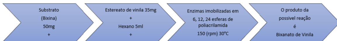
Figura 18 - Esquema reacional de esterificação enzimática das reações 1.
