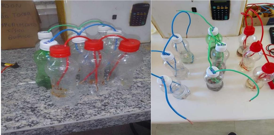
**Figura 7:** Experimento de baterias com garrafas pet.
