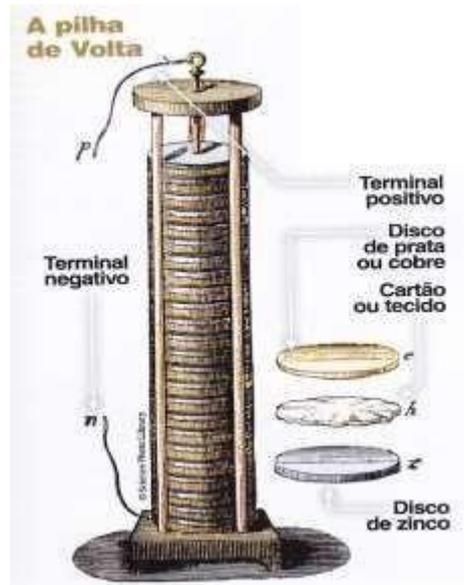
**Figura 1:** Esquematização de pilha construída por Alessandro Volta
