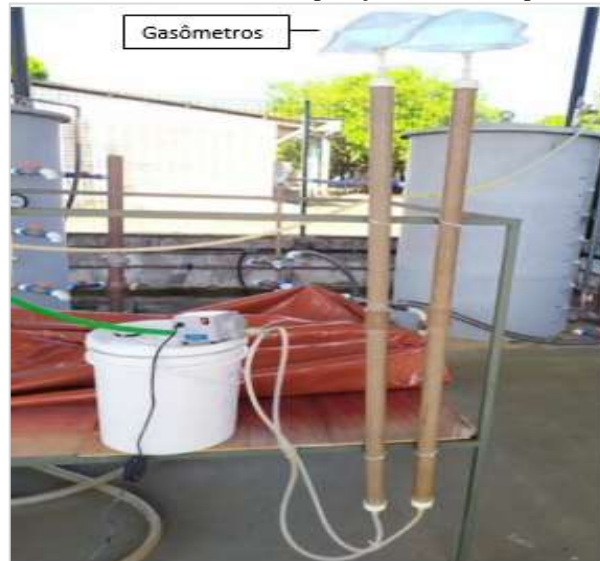
Figura 12 - Sistema de filtros em operação ao final do primeiro ciclo
