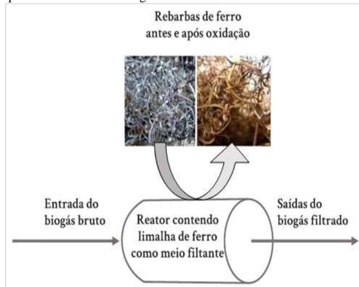
Figura 6 - Esquema de um filtro de biogás contendo limalha de ferro como material adsorvente
