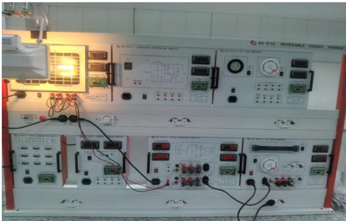
Figura 25- Módulo Inversor CC/CA com carga
