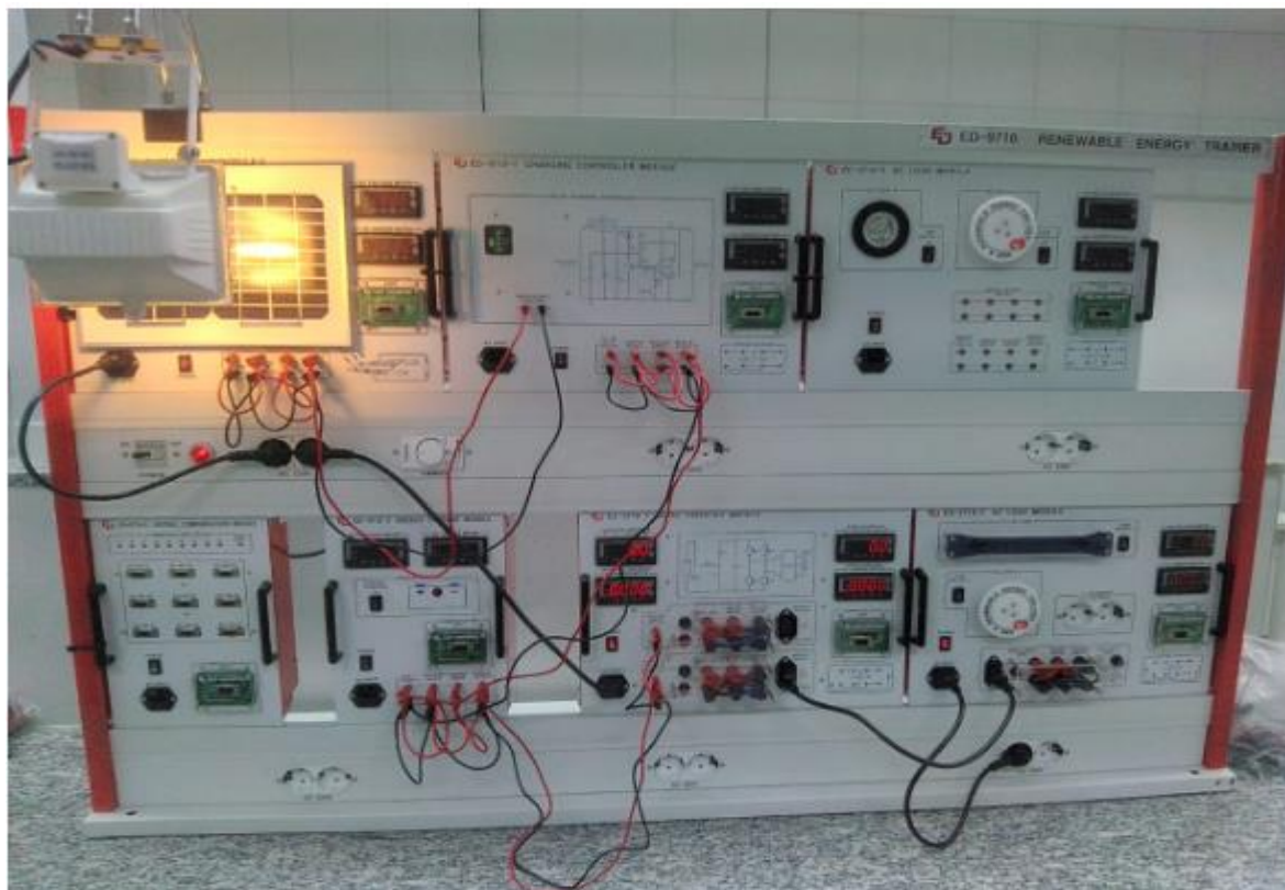
Figura 33- Módulo armazenamento de energia alimentando uma carga cc/ca
