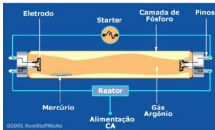
Figura 6- A composição básica da lâmpada tubular
