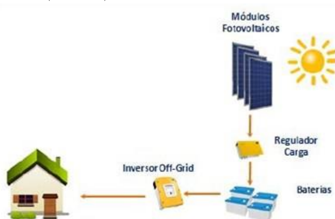
Figura 2 – Sistema Isolado (Off-Grid)
