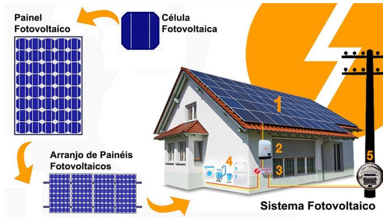
Figura 1 – Sistema Solar Conetado a Rede (Grid-tie)
