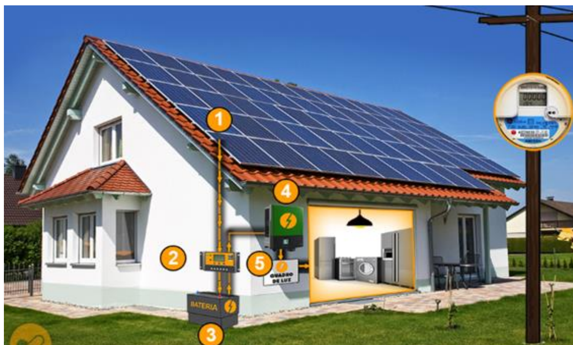
Figura 8 - Sistema isolado ( Off-grid )
