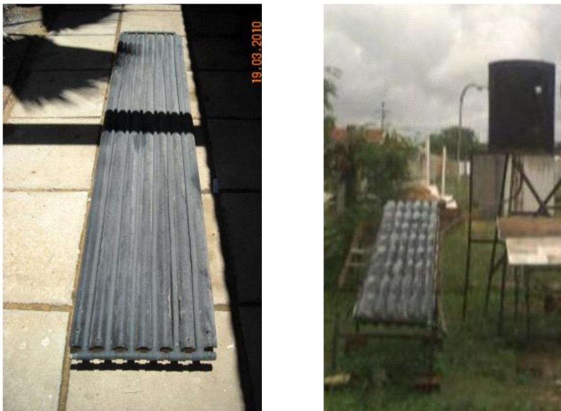
Figura 2 - Coletor solar alternativo em estudo: configuração I (à esquerda) e configuração II (à direita)
