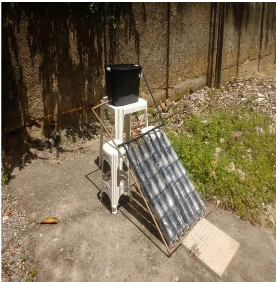
Figura 6 - Protótipo de aquecedor solar em funcionamento
