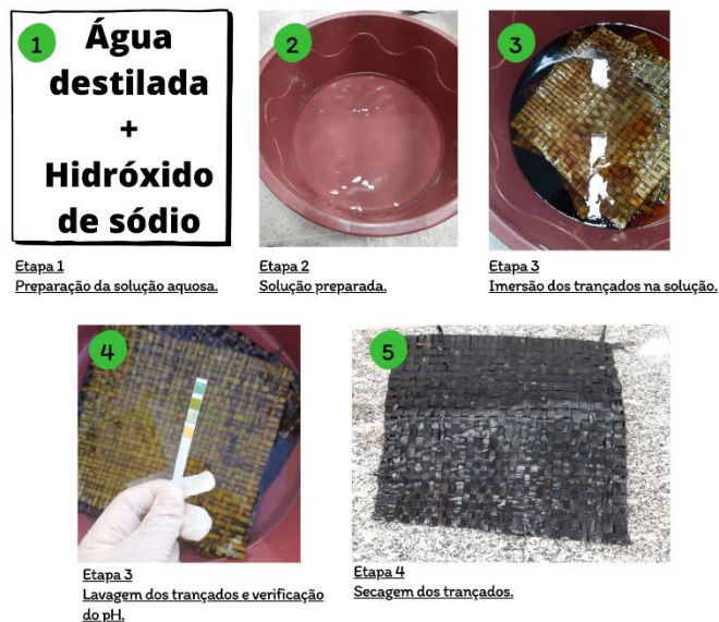
Figura 6 - Metodologia do tratamento químico dos trançados de carnaúba.
