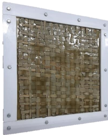
Figura 8 – Compósito no molde de laminação.
