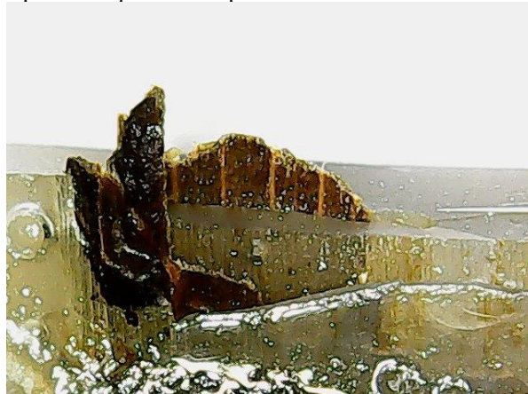
Figura 26 – Ruptura compósito com palha tratada com 5% de NaOH (1,25 mol/L).
