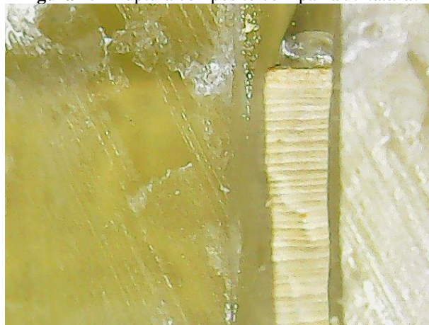
Figura 25 – Ruptura compósito com palha in natura .
