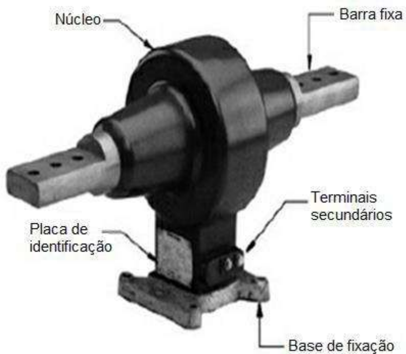
Figura 12 - Transformador de corrente de média tensão
