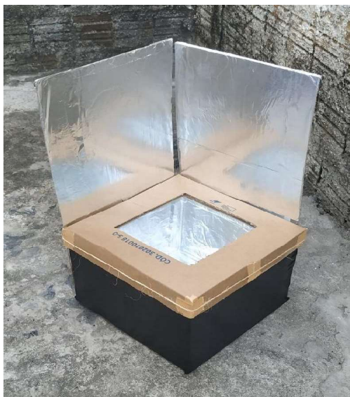
Figura 7: Fogão solar caseiro do tipo caixa
