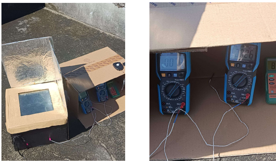
Figura 10: Registros dos testes com a placa de alumínio
