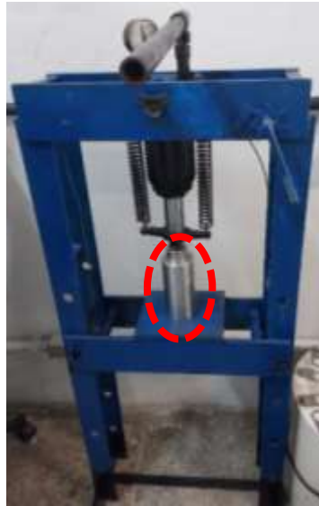
Figura 10 - Molde na prensa hidráulica
