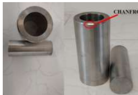
Figura 7 - Molde de aço inox SAE 304
