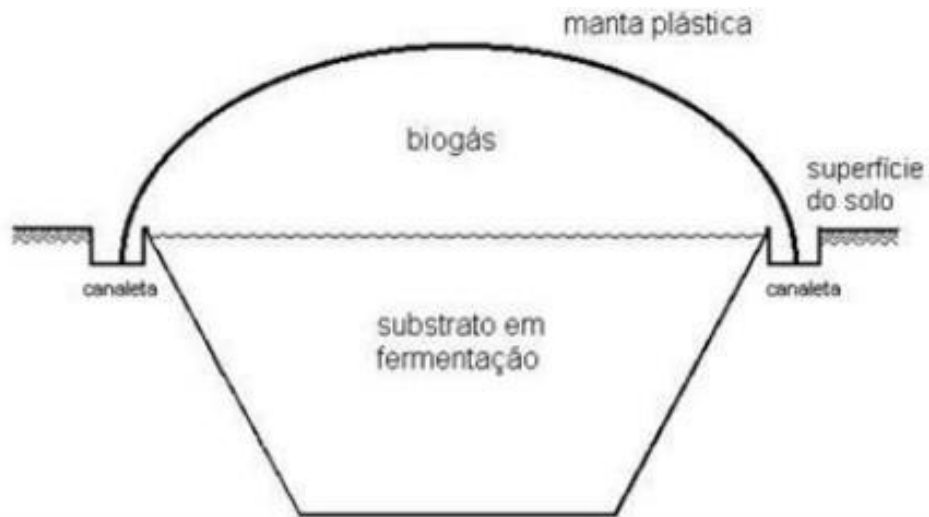
Figura 5 – Representação do biodigestor canadense.
