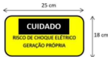
Figura 9 - Modelo da placa que será utilizada.
