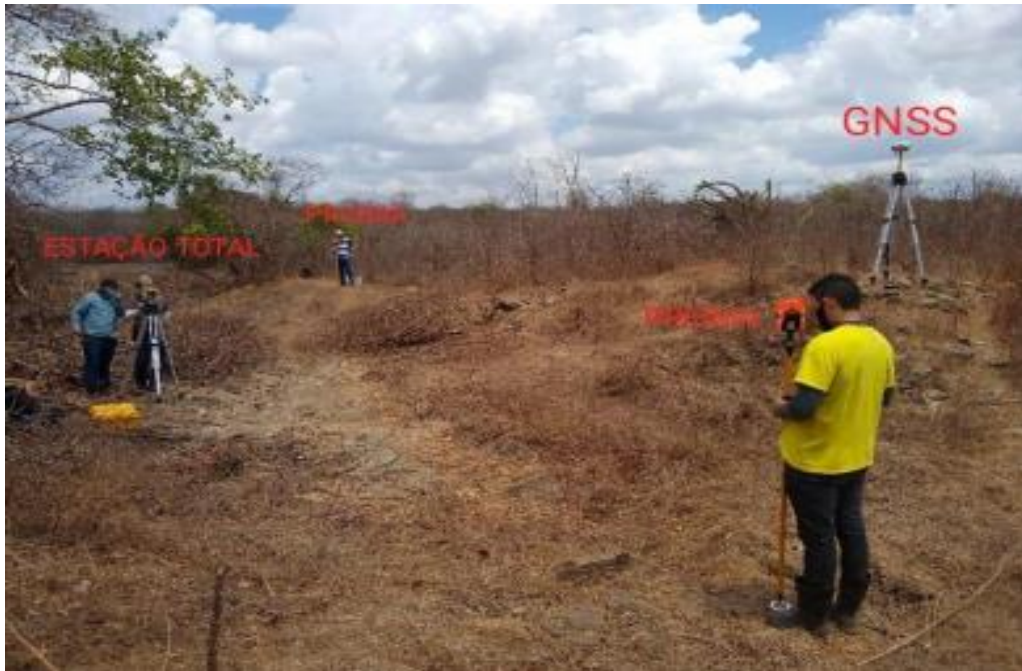
Figura 4 – Levantamento topográfico da área de inundação do açude escola
