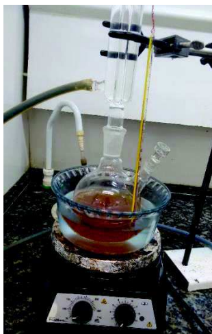
Figura 18 – Reação de transesterificação da amostra de 2016
