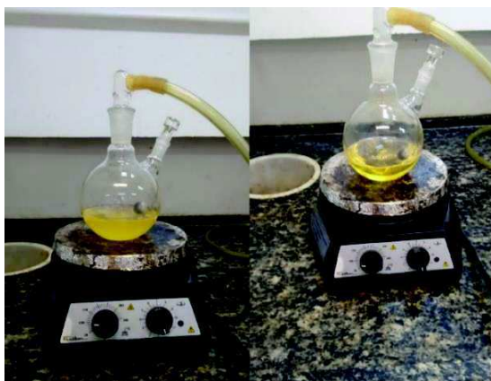
Figura 21 – Processo de secagem do biodiesel
