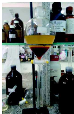
Figura 19 – Separação da glicerina do biodiesel
