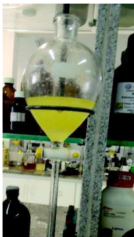
Figura 20 – Lavagem com água destilada do biodiesel (2016)
