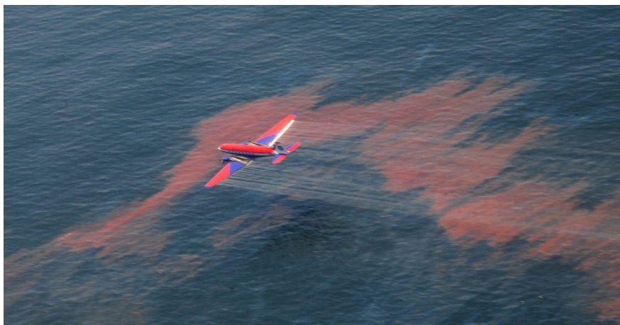
Figura 5 – Aplicação de dispersantes em mancha de óleo no mar.
