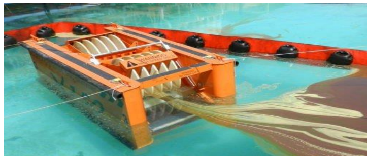
Figura 3 – Skimmers destinados a fazer a remoção do óleo confinado nas barreiras de contenção.
