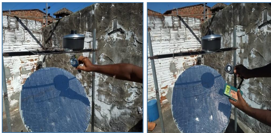
Figura 11- Medições das tempeturas e radiação
