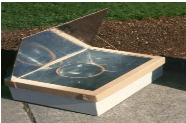
Figura 6- Fogão solar de tipo caixa
