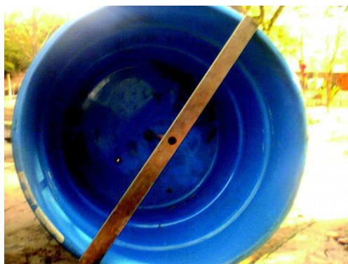
Figura 29 - Base para instalação e sustentação do cano guia Fonte: a autora
