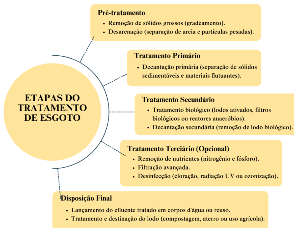
Figura 1 – Etapas do tratamento de esgoto
