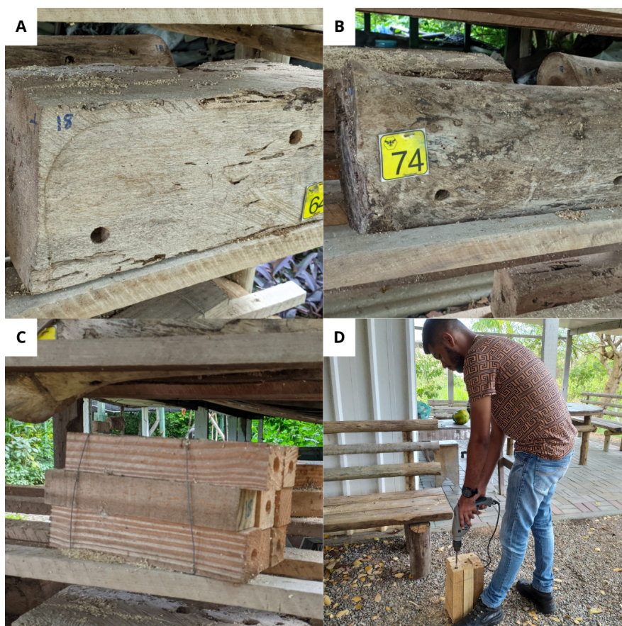
Figura 2: Blocos dos substratos utilizados: a) coqueiro; b) timbaúba; c) pinus; d) detalhe para os furos.
