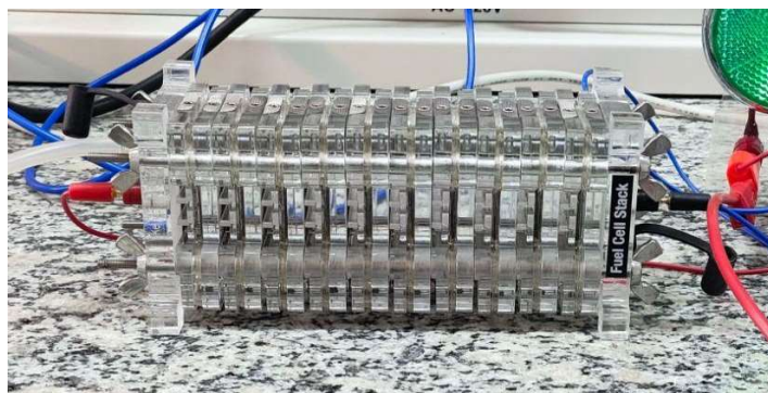
Figura 02 – Célula Combustível PEMFC
