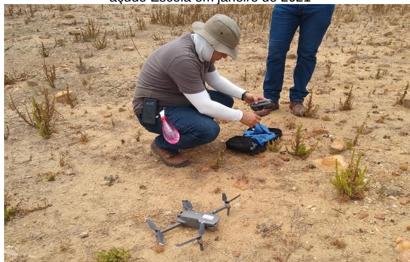
Figura 6 – Detalhes do drone ainda em solo para levantamento topográfico da área de inundação do açude Escola em janeiro de 2021
