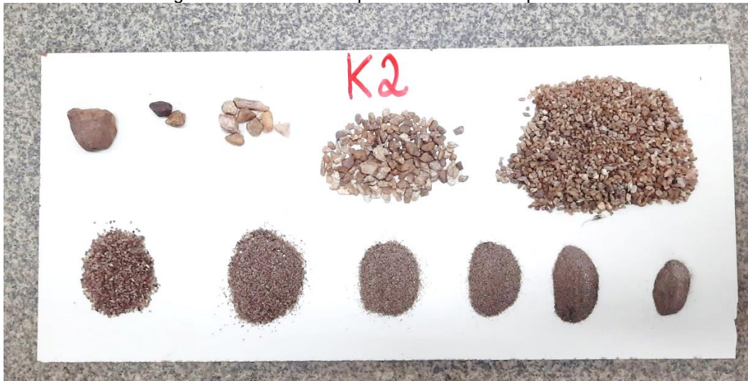
Figura 14 – Material do ponto K2 retido nas peneiras
