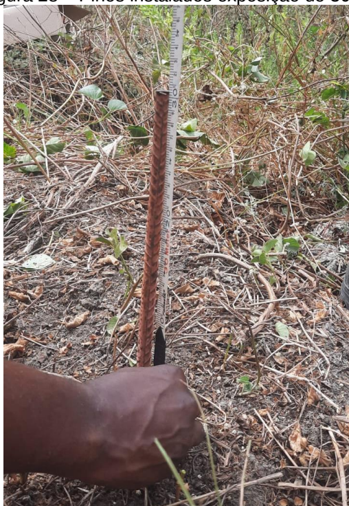
Figura 28 – Pinos instalados exposição de 30cm
