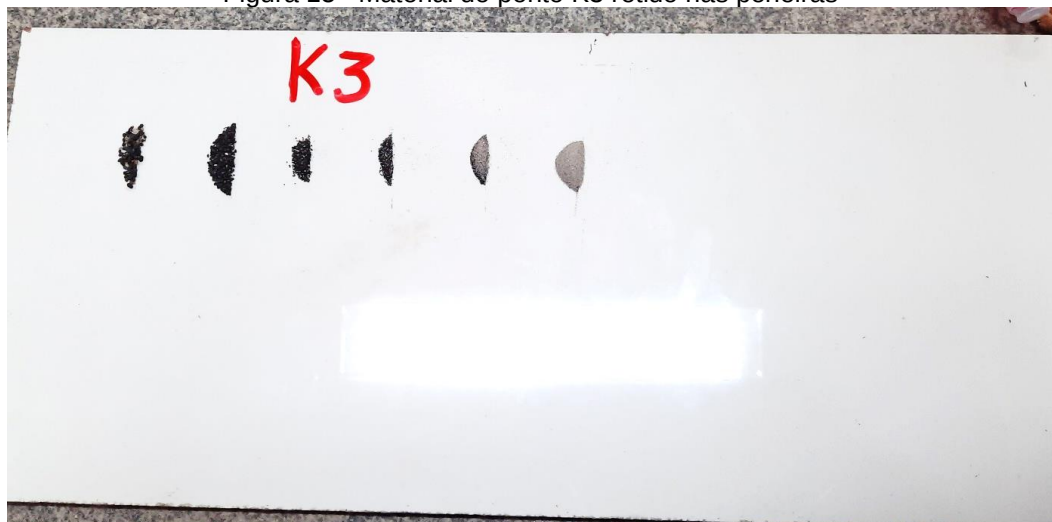
Figura 15– Material do ponto K3 retido nas peneiras
