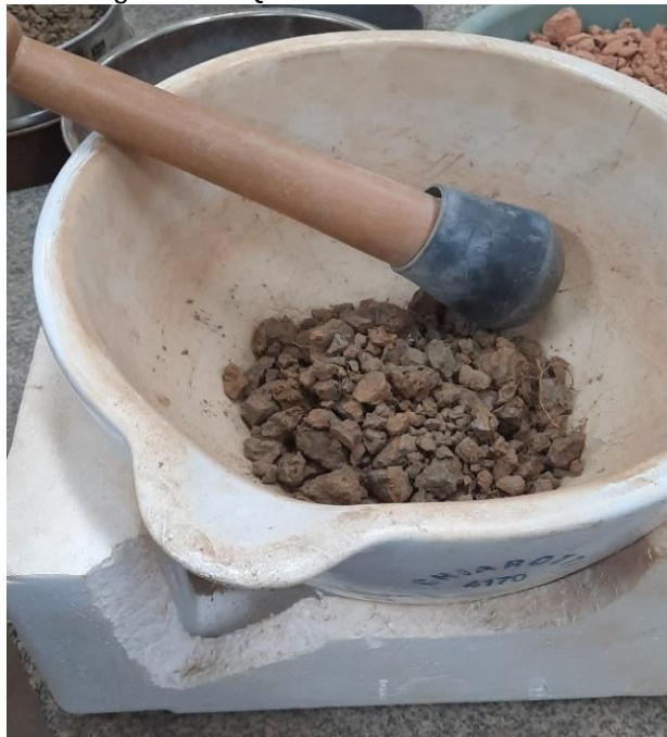
Figura 17 – Quebra dos torrões do solo
