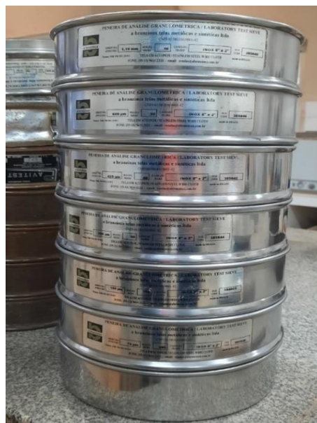
Figura 10 – Série de peneiras utilizadas de abertura de malhas conhecidas
