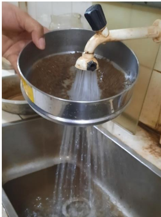
Figura 12 – Lavagem do solo com água corrente
