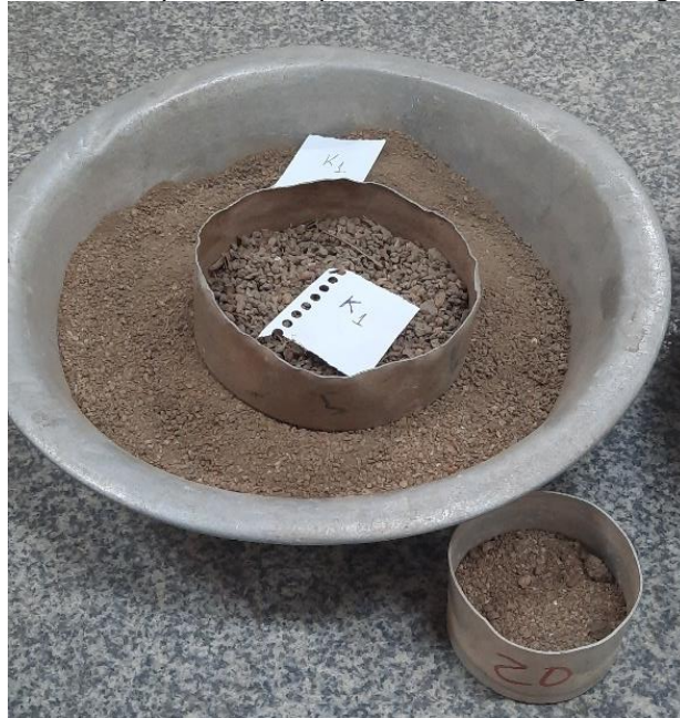
Figura 11 – Amostra do ponto K1 separada em solo de grãos grossos e finos
