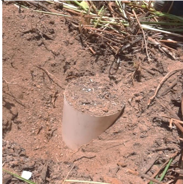
Figura 9 – Obtenção da amostra de solo através de cilindro
