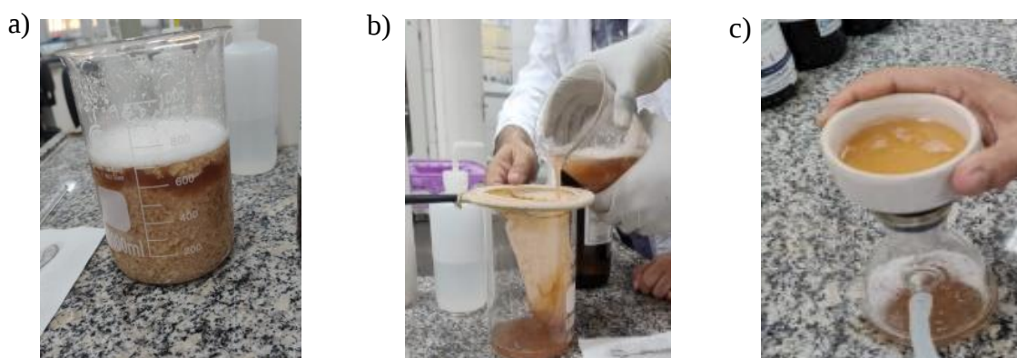
Figura 7 - Partículas de batata em meio aquoso (a), filtração comum da mistura (b) e filtração a vácuo (c)
