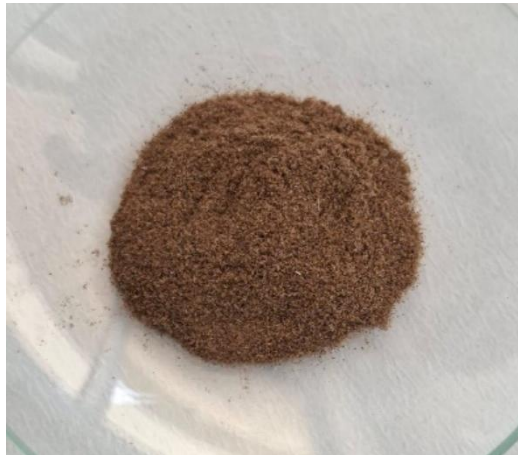
Figura 4 - Resíduo do pseudocaule bananeira peneirado (80 mesh) após os processos de lavagem, secagem e processamento.
